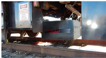
*A implantação do GPR integrado da Loram utiliza uma blindagem eletromagnética especial para produzir uma "caixa de absorção de eco" para permitir que as antenas sejam colocadas sob os veículos ferroviários. As informações podem ser coletadas com assistência mínima a bordo, a uma velocidade de até 125 mph com coleta de dados a cada 8 polegadas.*
