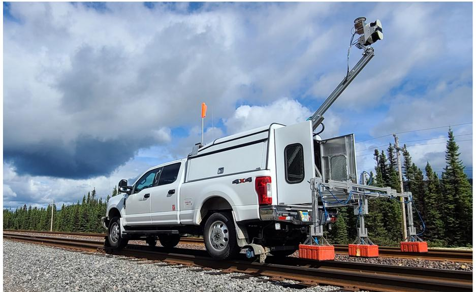
*A antena GPR de 400 MHz da Loram é capaz de coletar dados a uma profundidade máxima de 9 pés. Para uma penetração mais profunda, a Loram implanta antenas de baixa frequência, como uma antena de 270 MHz, conforme a necessidade, que tem uma profundidade máxima de penetração de cerca de 16 pés.*
