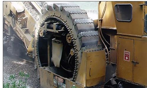
**Roda de draga.** Duas rodas de draga rasgam o lastro compacto a uma profundidade de até 16 polegadas (400 mm) a partir da parte inferior do dormente. Cada roda tem 30 polegadas (760 mm) de largura para permitir a limpeza a partir das extremidades dos dormentes até a borda do ombro.
