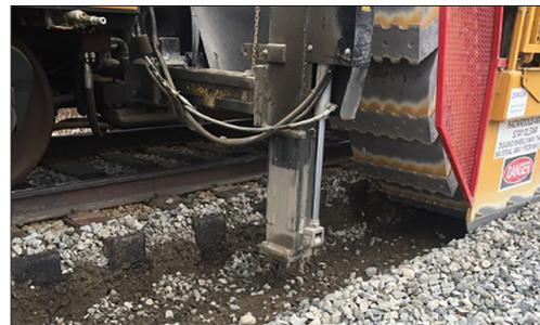
**Dente escarificador.** Os dentes do escarificador em cada lado da máquina erodem as extremidades dos dormentes reduzindo-as a 130 mm (5 polegadas), desfaçando bolsões de lama e restaurando a drenagem.
